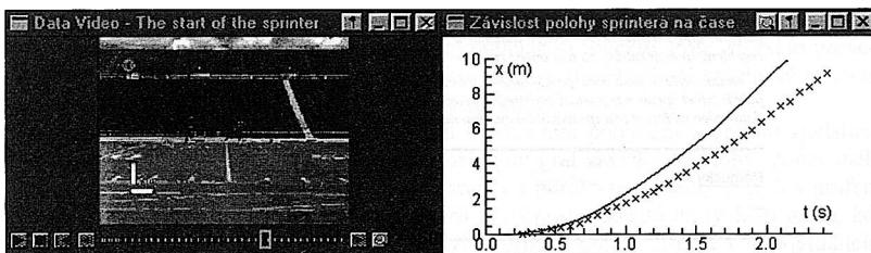
Obr. 3: Předpověď studenta a naměřená závislost vodorovné složky polohy sprintera na čase (pro měření z videozáznamu, na němž pohyb sprintera nezačíná v časovém okamžiku 0 s)
