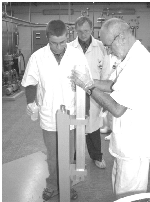
Obr. 14 Kontrola paliva IRT-4M kalibrem
