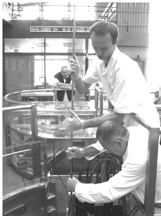
Obr. 15 Zakládání detektorů neutronů PMV pro měření výkonu
