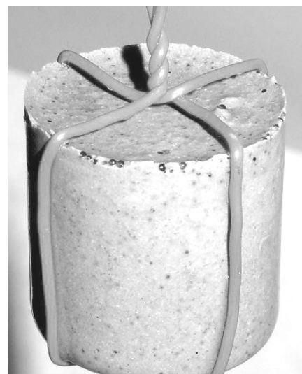
Obr. 1 Vzorek produktu SIAL s fixovaným kalem s ionexy
