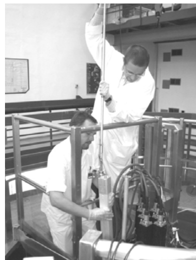
Obr. 16 Zakládání palivového článku IRT-4M do aktivní zóny
