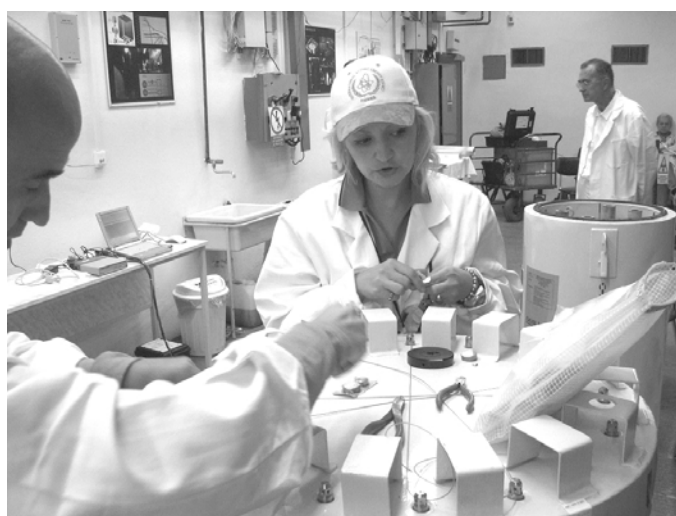
Obr. 9 Inspektory IAEA při pečetění transportních kontejnerů se starým palivem IRT-3M
