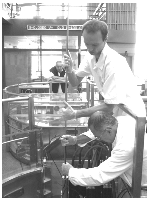
Obr. 15 Zakládání detektorů neutronů PMV pro měření výkonu
