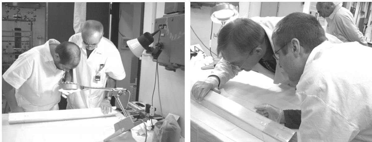
Obr. 12 a 13 Pečlivá přejímka nového paliva IRT-4M na reaktoru VR-1
