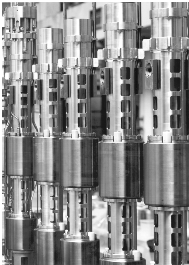
Obr. 1 Modernizovaný lineární krokový pohon řídicích tyčí LKP-M pro reaktory VVER 1000 – montáž bloku elektromagnetů
