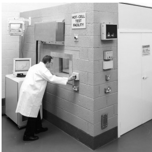
Obrázek 5 Práce se zdroji ionizujícího záření, jako stínění je použita betonová zeď a průzor z olověného skla
