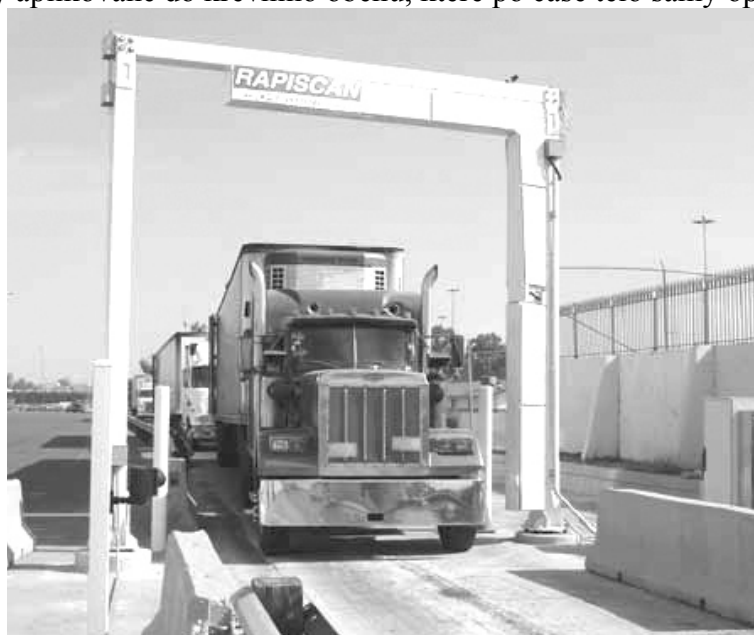
Obrázek 6 Rámový detektor pro kontrolu kontaminace nákladních vozidel
