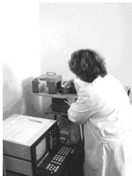
Obr. 1 Měřicí sestava – vkládání vzorku do stínění
