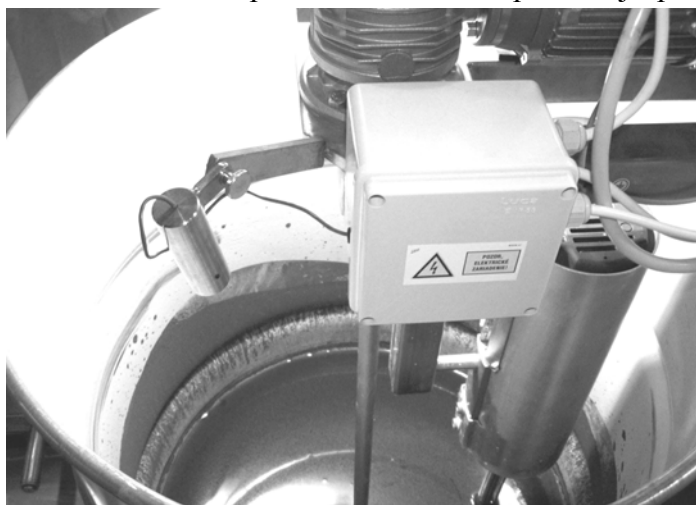
Obr. 2 Pohled do sudu s kalem ve fixačním zařízení před zpracováním do matrice SIAL
