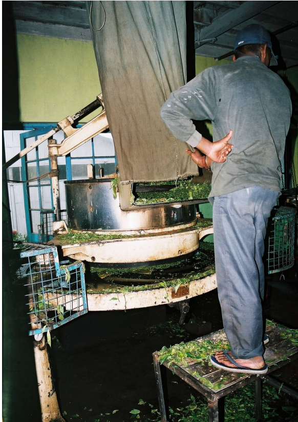
obr. 5: Zavadlé listy se svinují na speciálních strojích, aby v nich mohla probíhat fermentace.
