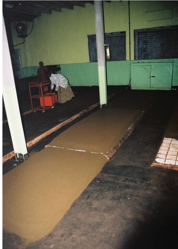
obr. 6: Fermentace. Svinuté čajové listy se rovnají do silné vrstvy, v níž za přísně střežených podmínek (teplota a vlhkost) probíhají enzymatické přeměny látek – je odbouráván chlorofyl a třísloviny, uvolňují se aromatické látky a kofein.
