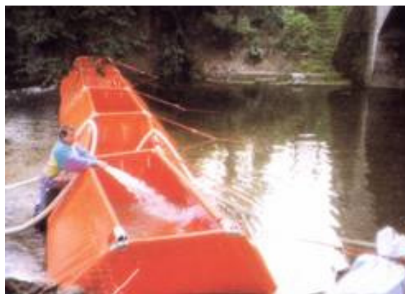
obr. 4: povodňová zábrana – výrobce firma Alba Metal (ČR)
