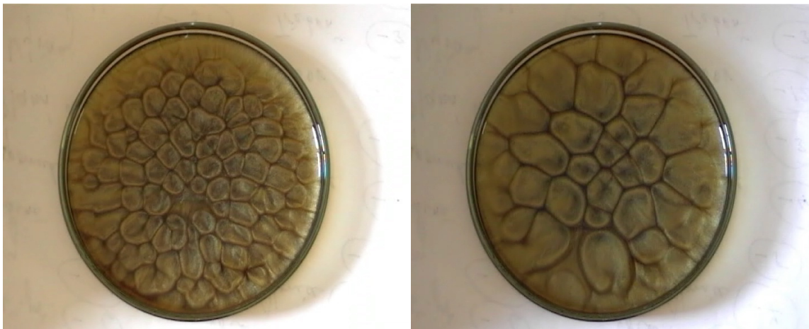
obr. 3: Bénardovy buňky. Vlevo větší vertikální gradient teploty T , vpravo menší [foto autor]
