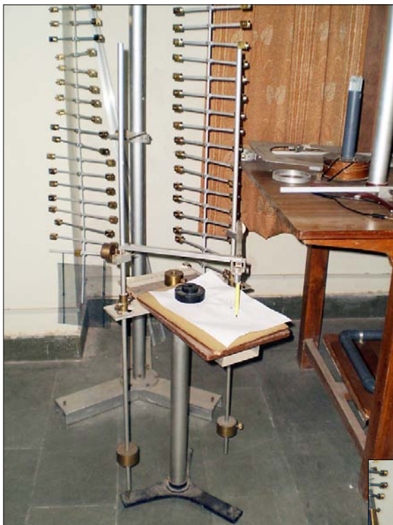
Obr. 9 – demonstrace skládání kolmých kmitů, „Lissajous apparatus“
