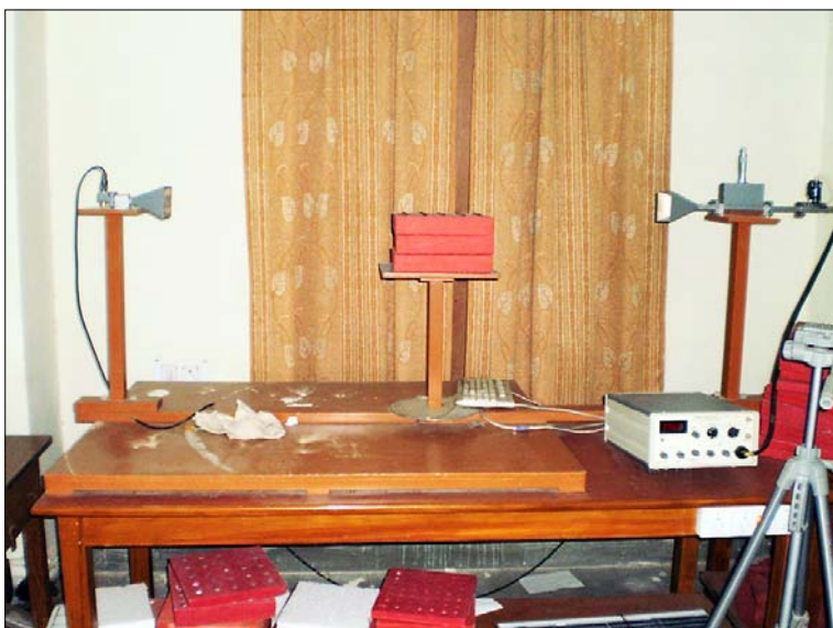
Obr. 13 – model difrakce na krystalech pomocí mikrovlnné soupravy
