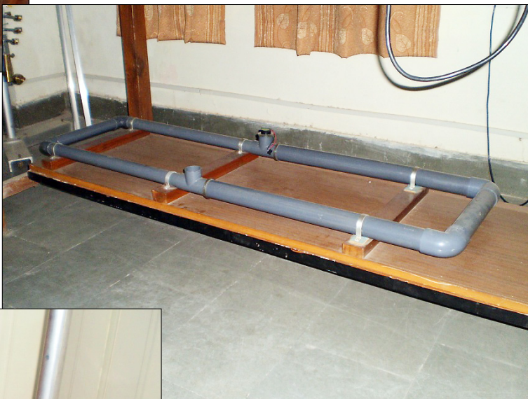
Obr. 11 – Quinckeho trubice z PVC
