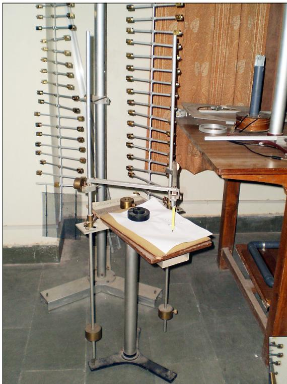
Obr. 9 – demonstrace skládání kolmých kmitů, „Lissajous apparatus“
