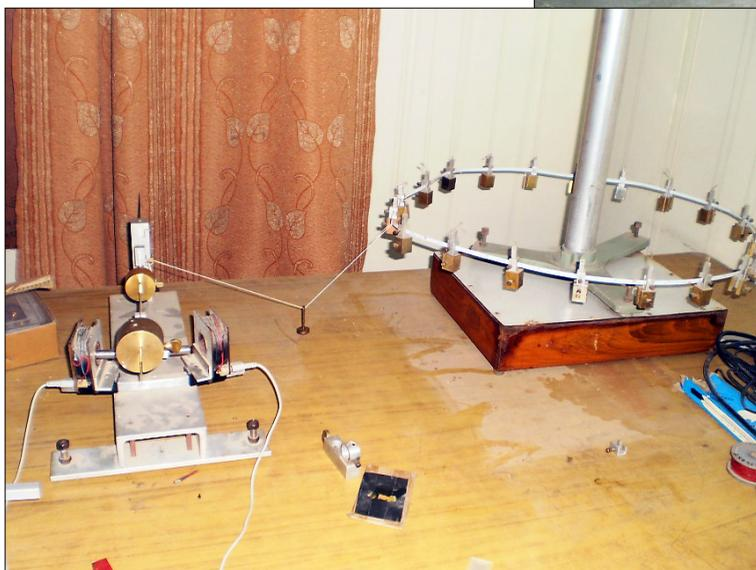
Obr. 12 – mechanický model Bohrova atomu
