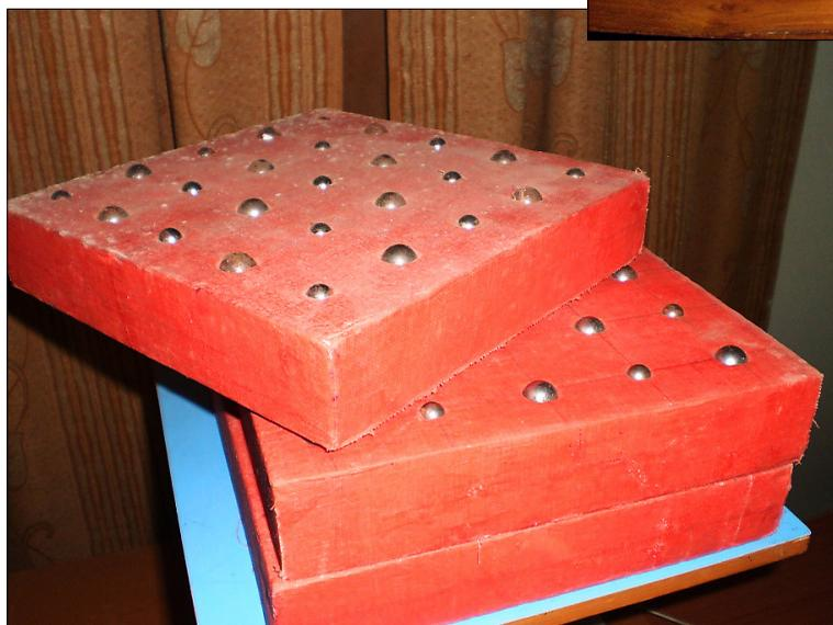
Obr. 15 – model krystalu pro demonstraci difrakce mikrovlnného záření
