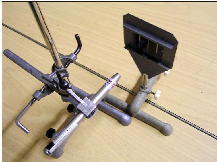
Obr. 1 – upevněné laserové ukazovátko
