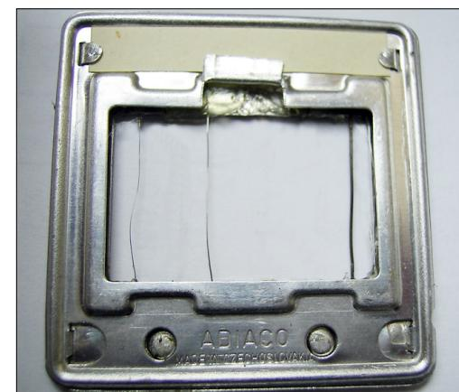
Obr. 4 – upevnění drátek
