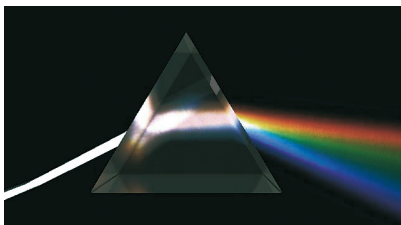
rozklad bílého světla lomem při průchodu skleněným hranolem
