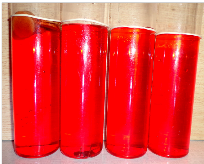
Obr. 6 – změny výšky hladiny pro různé varianty zadání; fotografie znázorňuje konečný stav po úplném roztátí ledu, gumíčkou je vždy označena původní výška hladiny; zleva led s korkem, led s napínáčkou (obdoba olověné kuličky), samotný led a led s bublinou vzduchu; klesne pouze hladina vody v nádobě ledu s kovem
